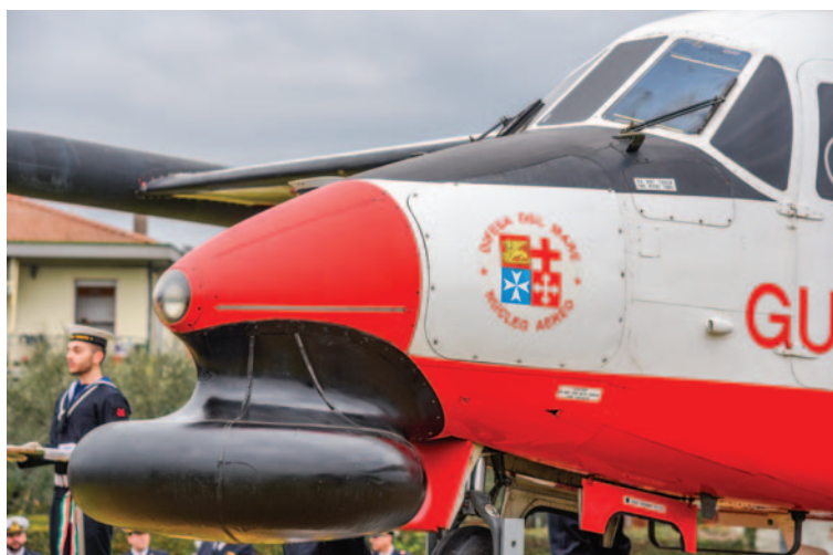
Particolare del Radar 360° contenuto in apposita struttura nel radome appoggiato al muso del velivolo.
