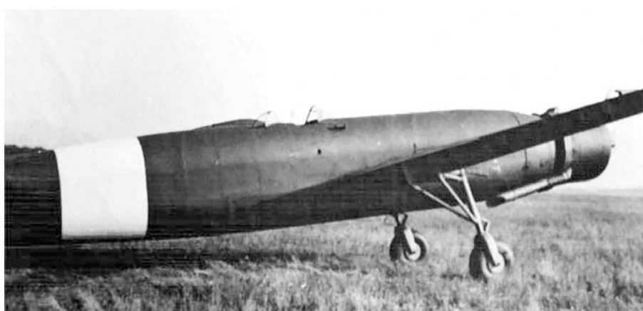
Ben visibile la relativa fragilità del carrello sganciabile dopo il decollo.
